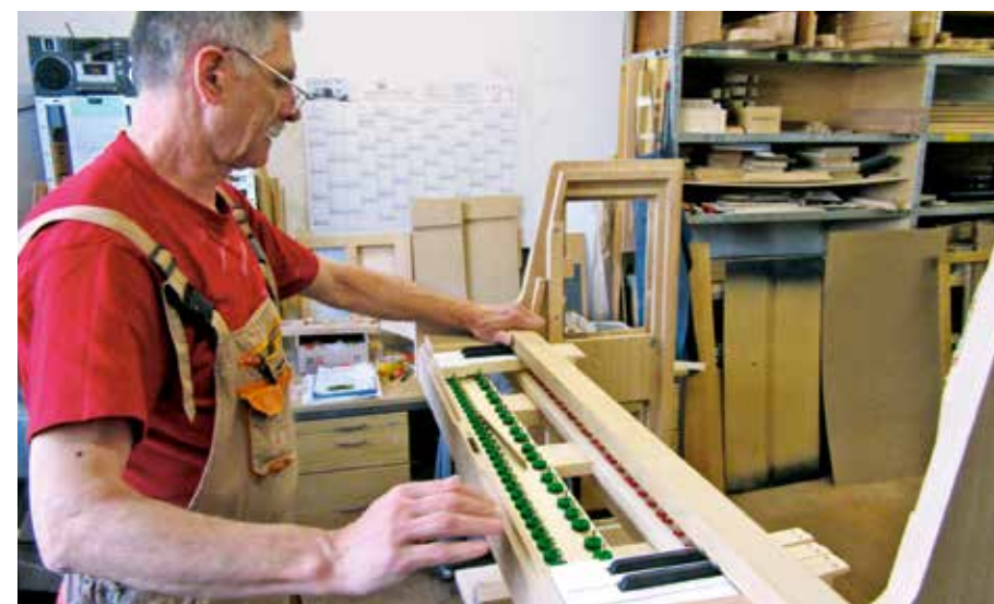
In der Werkstatt wird die Tastatur in ein Celesta-Gehäuse eingebaut.
