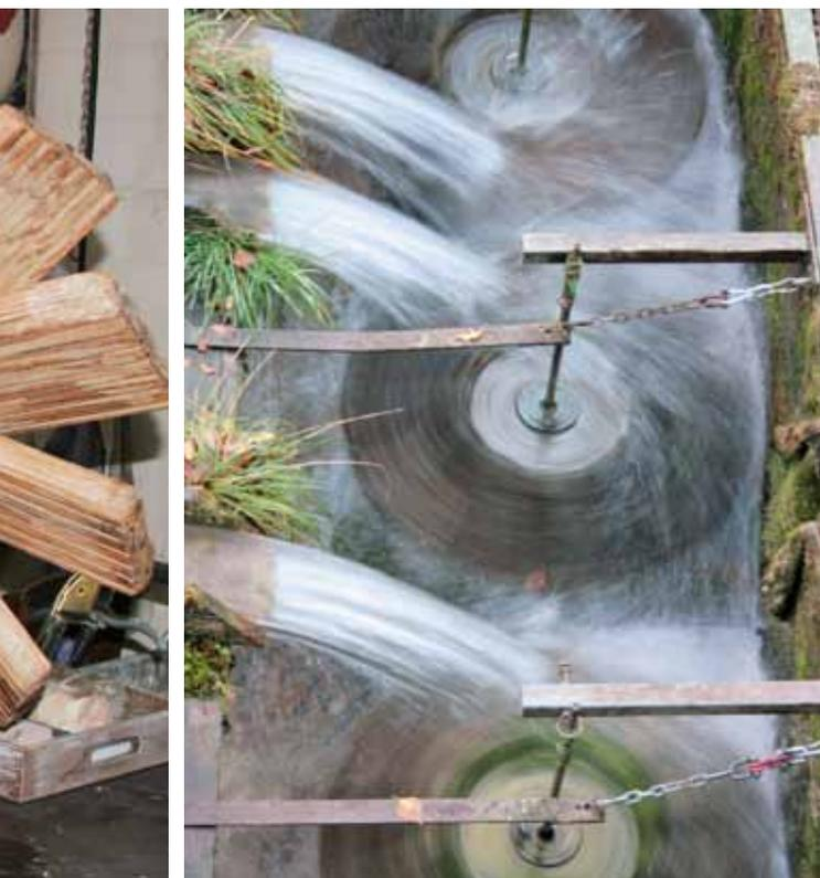
Die Wasserkraft des Seebachs treibt die Kugelmühlen an
